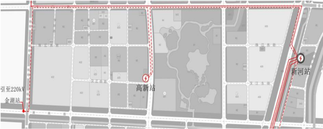
图 5-11 110kV 高新站进出线图
